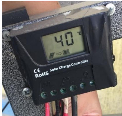
Fotografía 3. Controlador PWM. Fuente propia.
