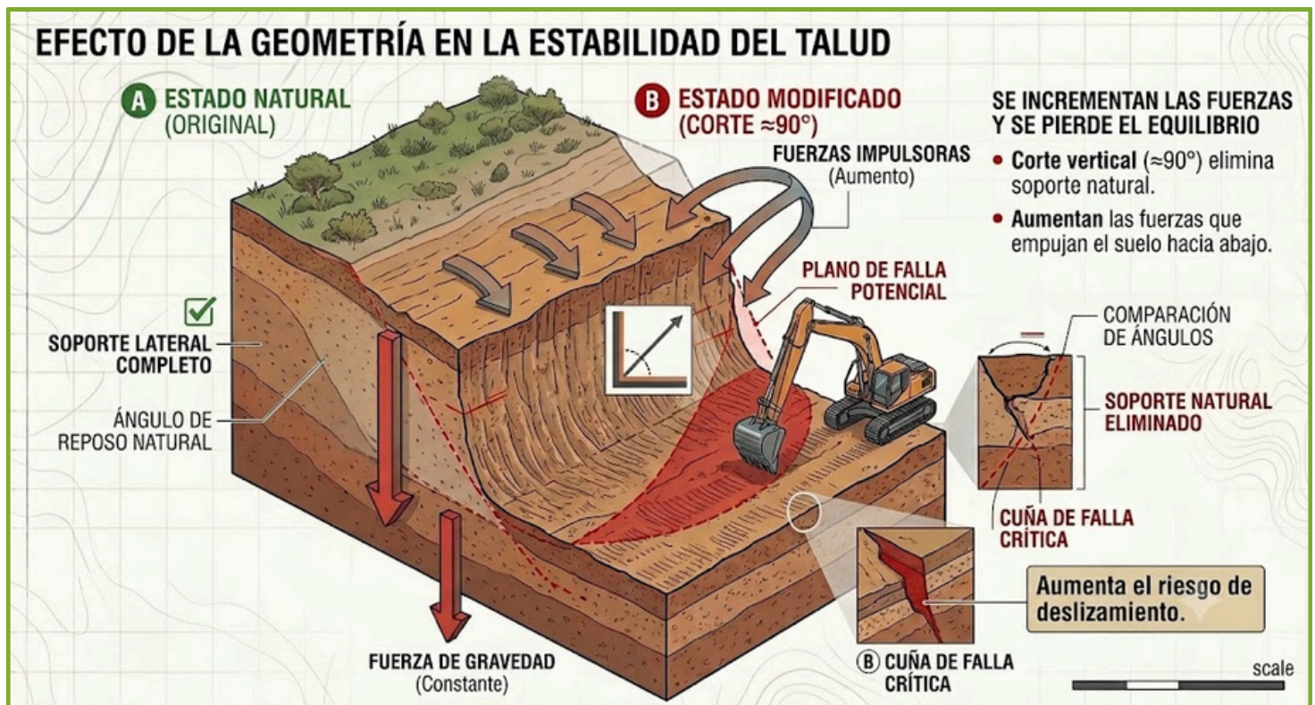
Figura 3. Efecto de la geometría en la estabilidad del talud.
