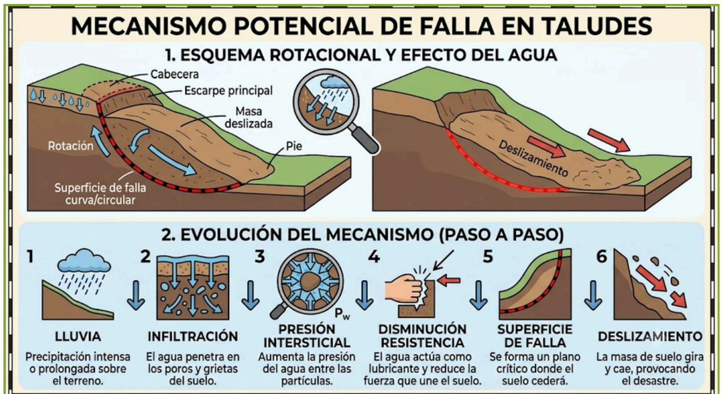
Figura 8. Mecanismo de falla rotacional en taludes.
