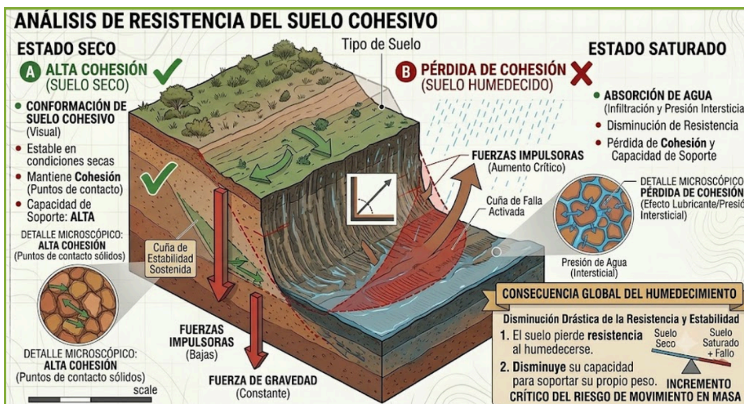
Figura 4. Efecto del tipo de suelo en la estabilidad del talud.
