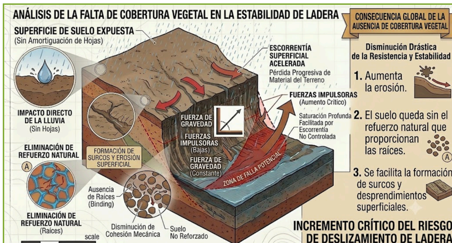
Figura 6. Efecto de la ausencia de cobertura vegetal en la estabilidad del talud.
