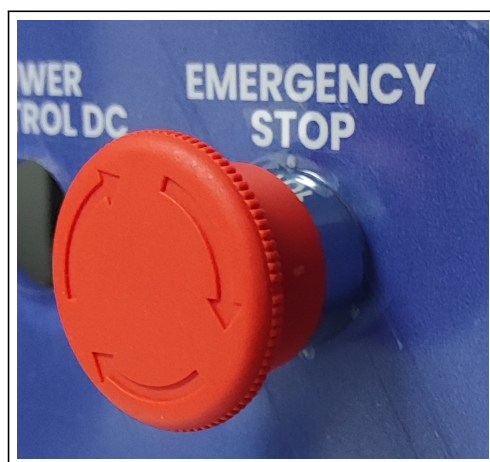
Figura 18: Botón de parada de emergencia tipo hongo. Fuente: Propia.
