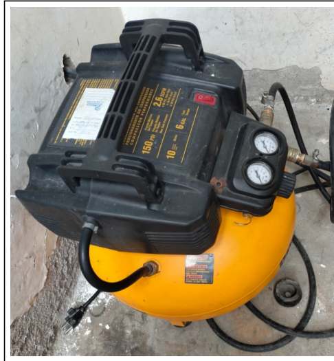
Figura 6: Compresor de aire de la planta de presión. Fuente: Propia.
