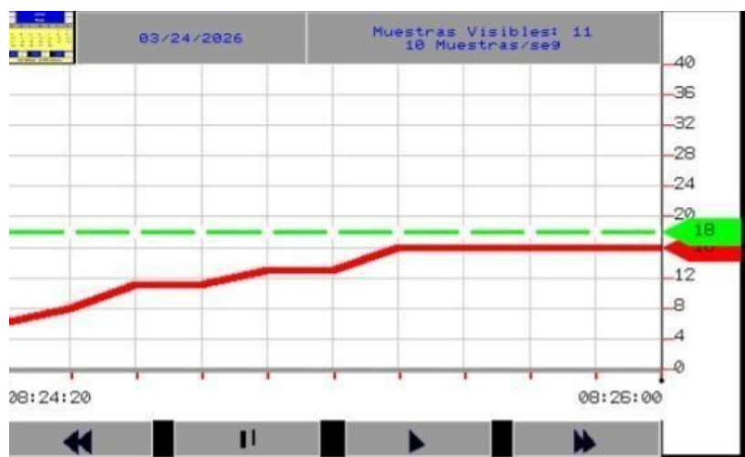
Fig. 24. Arranque del sistema con K_p=1000 y pendiente de llenado pronunciada.
