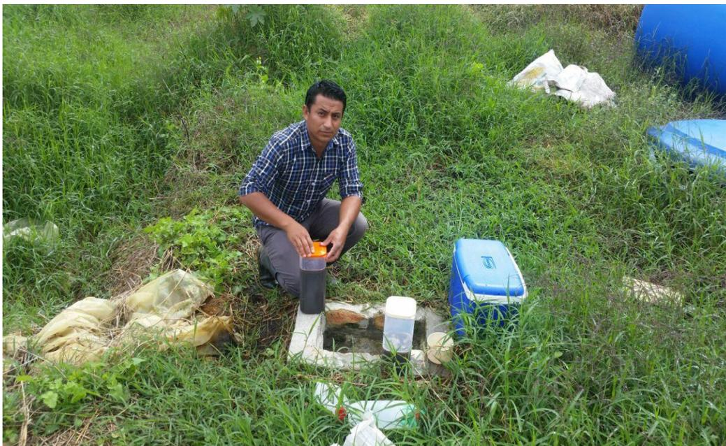
**Anexo D:** Toma de las muestras de campo en el punto de muestreo, rotulación, embalaje y transporte de la muestra para su posterior análisis correspondiente a la concentración de DBO<sub>5</sub>, DQO, SST y en la Ciudad de Popayán laboratorio CRC.
