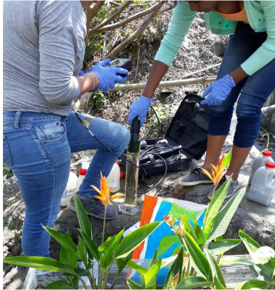
Imagen 8. Medición de parámetros in situ, con la ayuda de equipos potenciometricos.
