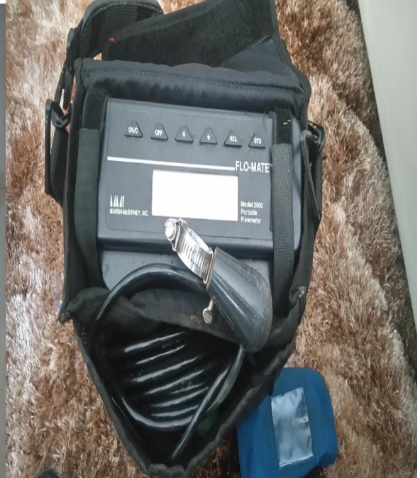
Molinete con sensor
