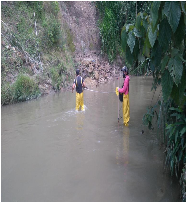
Aforo del caudal, estación tres.
