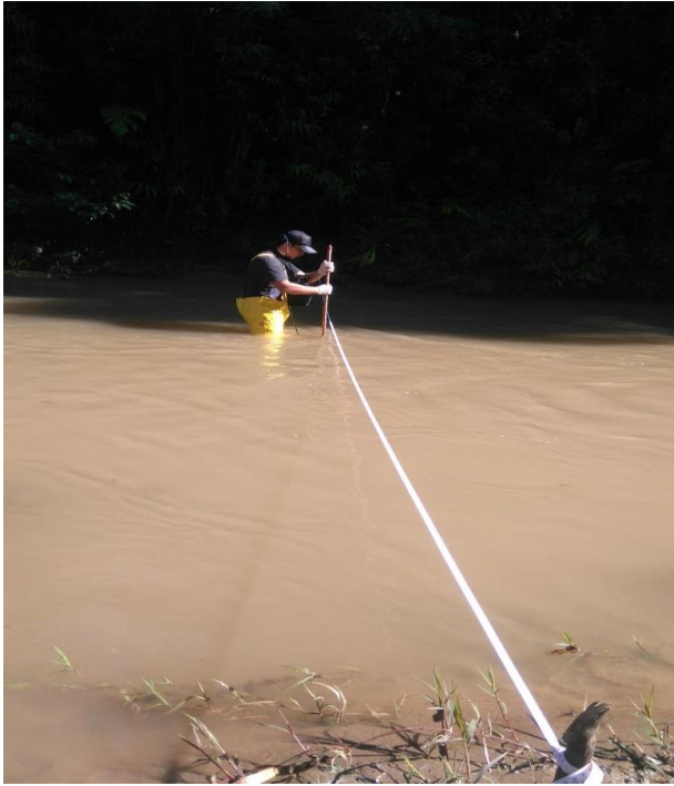
Aforo del caudal, estación uno.
