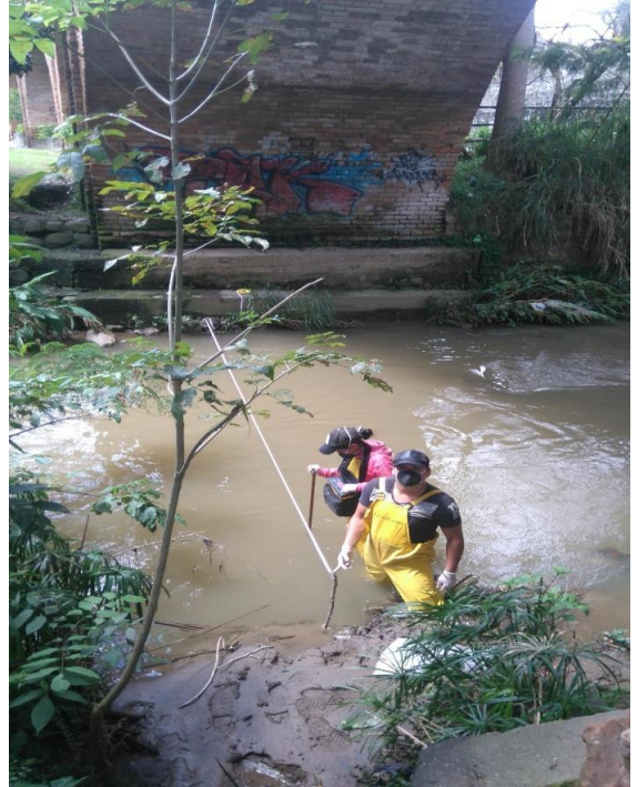
Aforo del caudal, estación dos.
