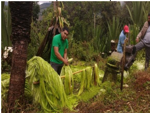
Figura 25. Proceso de desfibrado de las pencas de fique.
