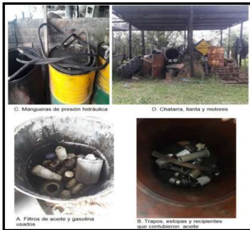
Imagen 21. Residuos RESPEL área de mecánica y soldadura
