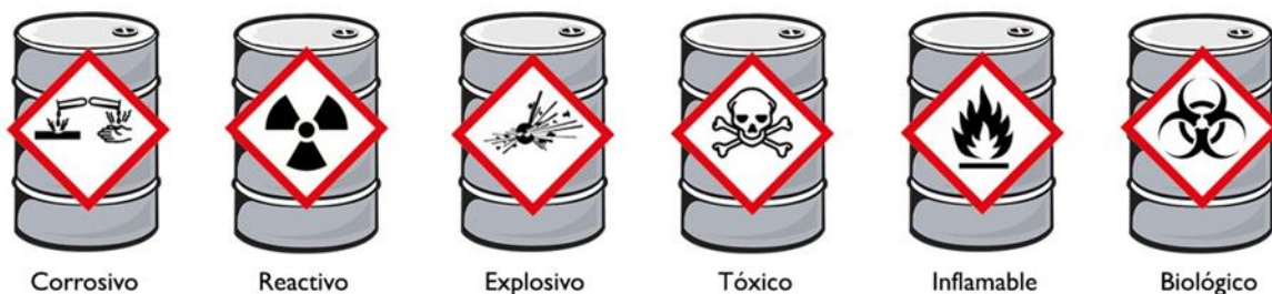
Figura 2. Identificación de Residuos Peligrosos
