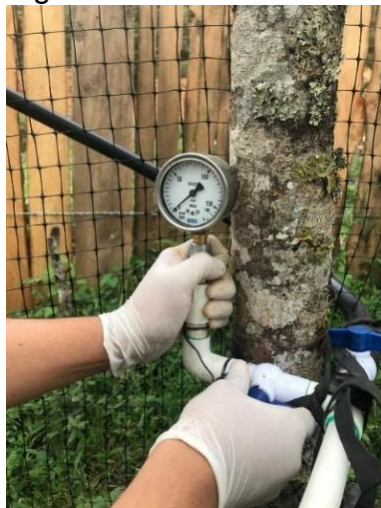
Figura 17. Manómetro instalado y esquema de su posición.
