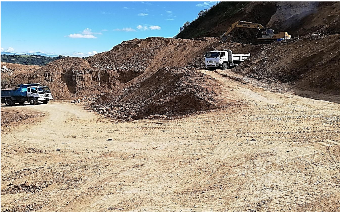
Figura 30. Explotación adecuada de la mina desde los bancos definidos. Tomada por: Kevin Bastidas, 2018
