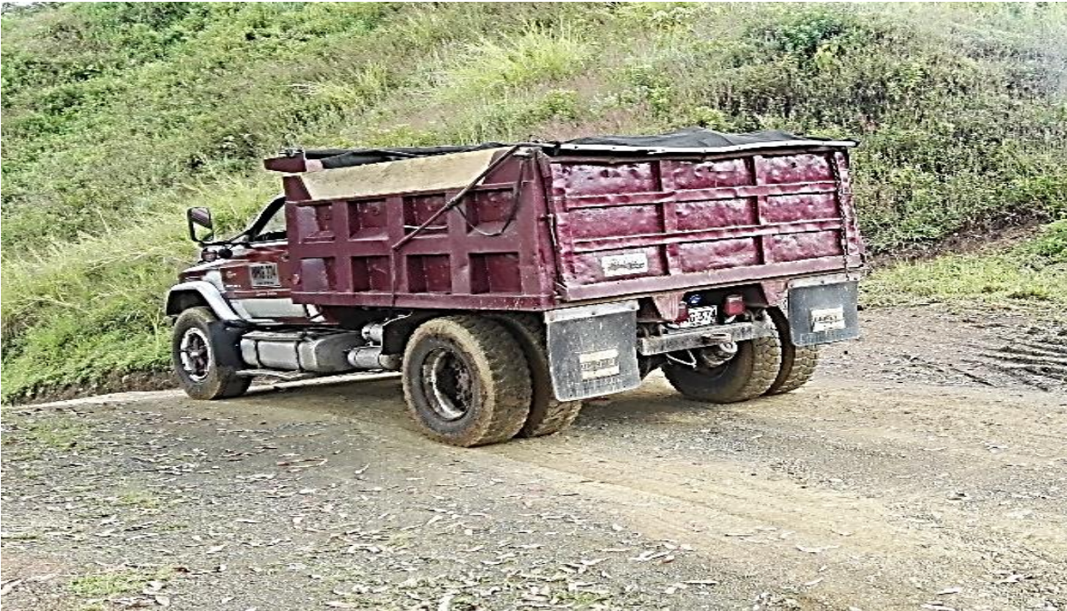
Fotografía N°8, Cubrimiento de carga, Tomada en el año 2018 por Kevin Bastidas, En Vía de acceso a los Bancos de explotación, MANEJO DE MATERIAL PARTICUALDO: CONTROL DE EMISIÓN DE MATERIAL PARTICUALADO Y VERTIMIENTO EN LAS VÍAS. TODAS LAS VOLQUETAS DEBEN IR RESPECTIVAMENTE CARPADAS.
