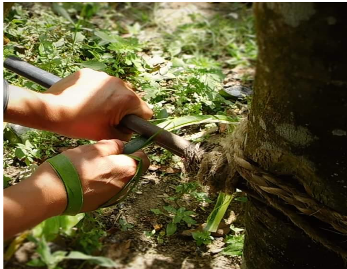
Figura 8. Desfibrado manual de fique.
