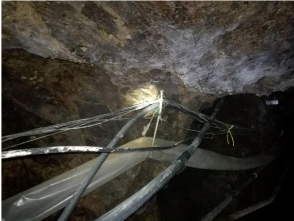
Socavón mina maribeles, conexiones artesanales
