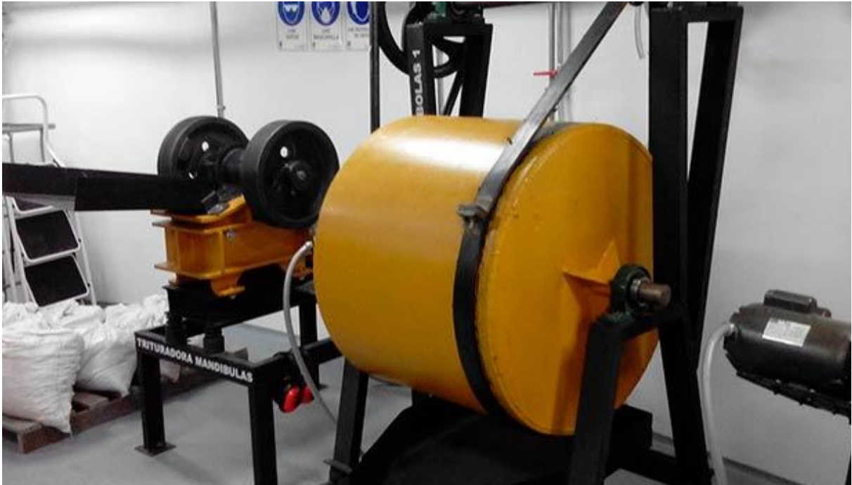
Figura 14. Planta piloto de beneficio cero mercurio
