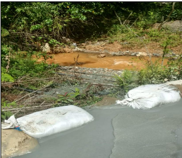
Figura 10 Dique de cola entable cooperativa, vertimiento a quebrada el Tamboral.
