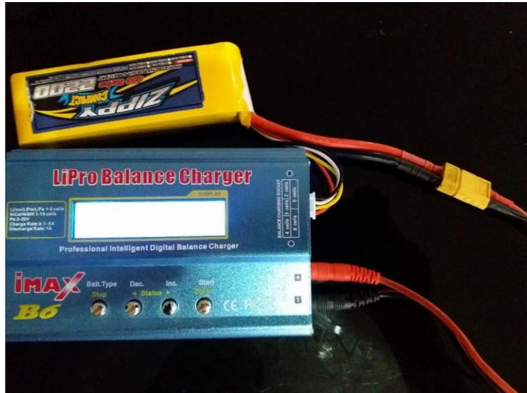
**Figura 61.** Batería conectada al cargador B6. [Fuente Propia]
