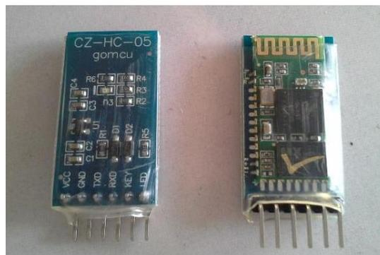
**Figura 35.** Dispositivo Bluetooth CZ-HC-05 gomcu. Fuente: [73].
