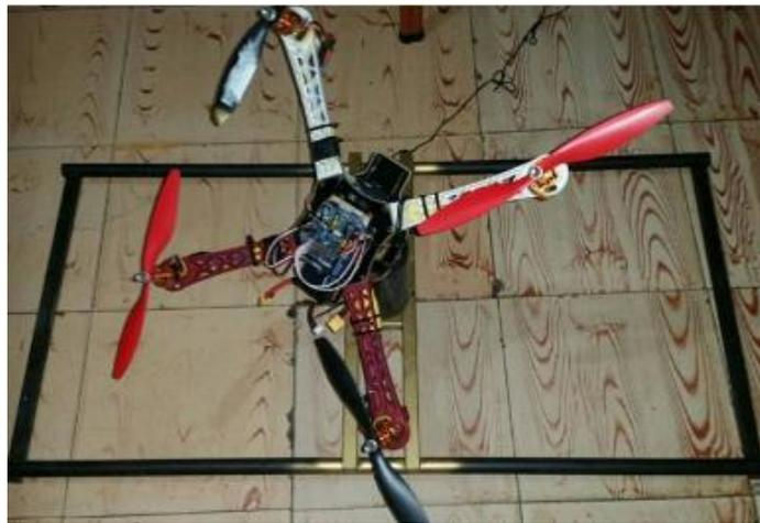
**Figura 39.** Base para pruebas del segundo cuadricóptero. Fuente: Propia.
