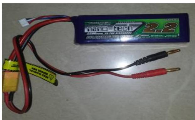
**Figura 25.** Batería LiPo 3S 2,200mAh. Fuente: propia.
