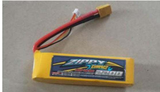
**Figura 26.** Batería LiPo ZIPPY 2200mAh, 3S. Fuente: propia.
