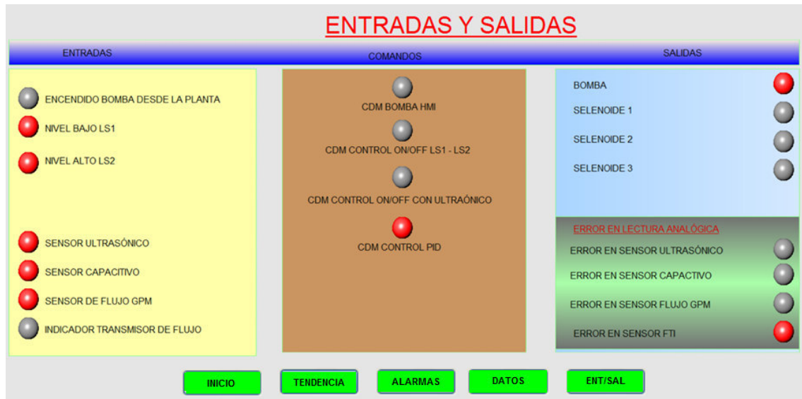
Figura 4.21: Entradas, comandos, salidas y errores en las lecturas análogas durante la ejecución del controlador PID. Fuente: Autor
