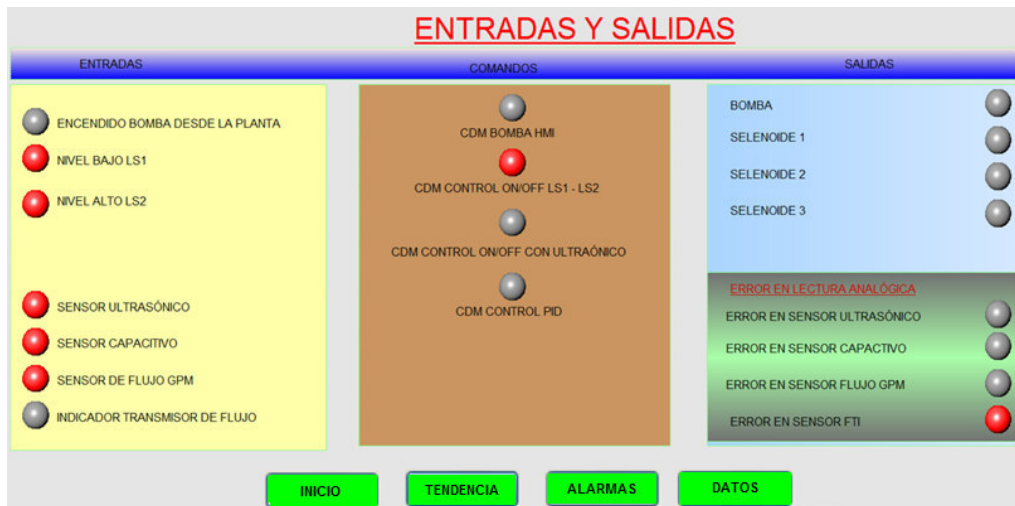
Figura 3.24: Pantalla de Entradas y Salidas. Fuente: Autor
