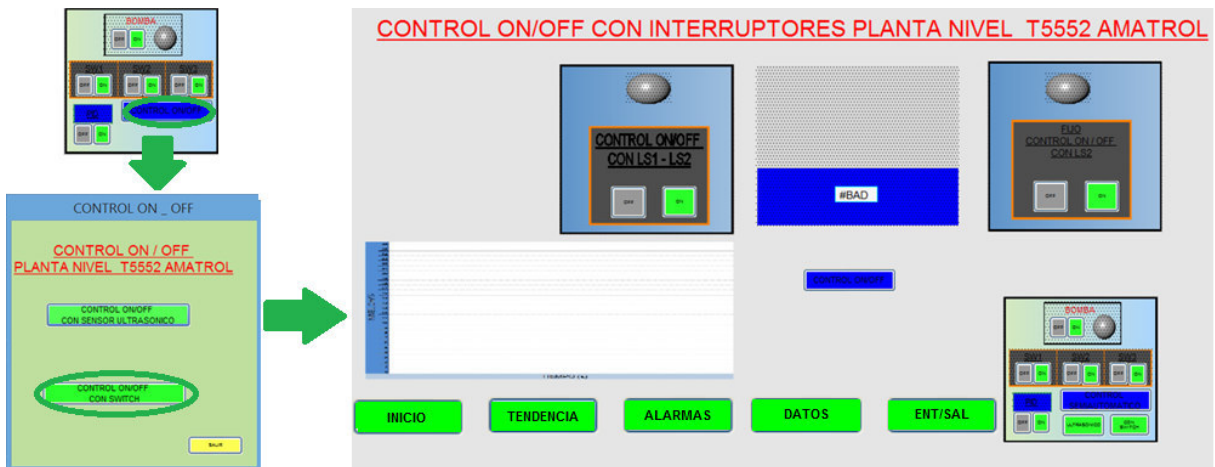
Figura 3.27: Pantalla de Control ON/OFF con Interruptores. Fuente: Autor
