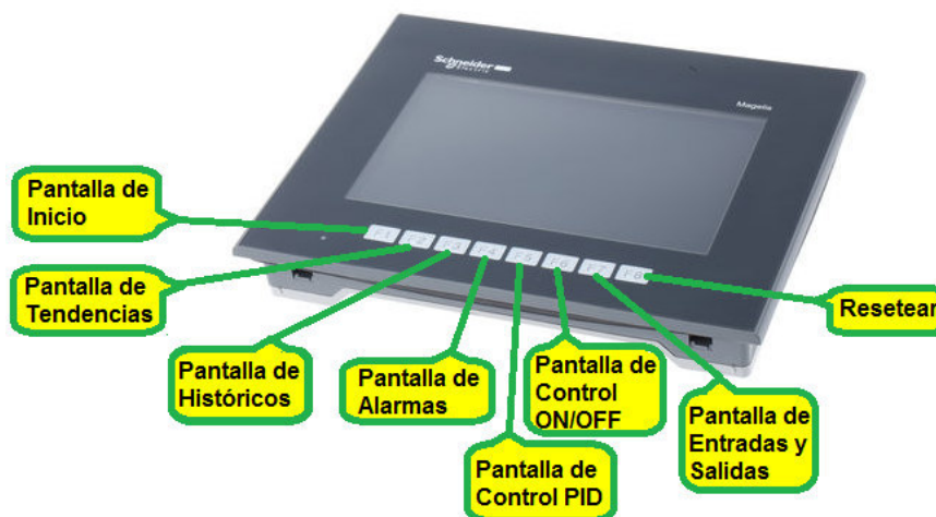
Figura 3.18: Configuración de las teclas de la pantalla. Fuente: Autor
