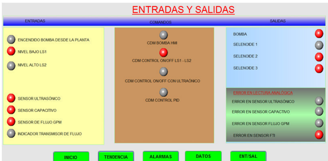
Figura 4.5: I/O activas en control ON/OFF rango variable con LS1-LS2. Fuente: Autor
