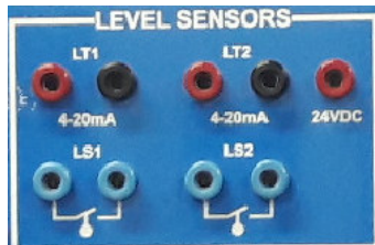
Figura 2.41: Level sensors. Fuente: Autor
