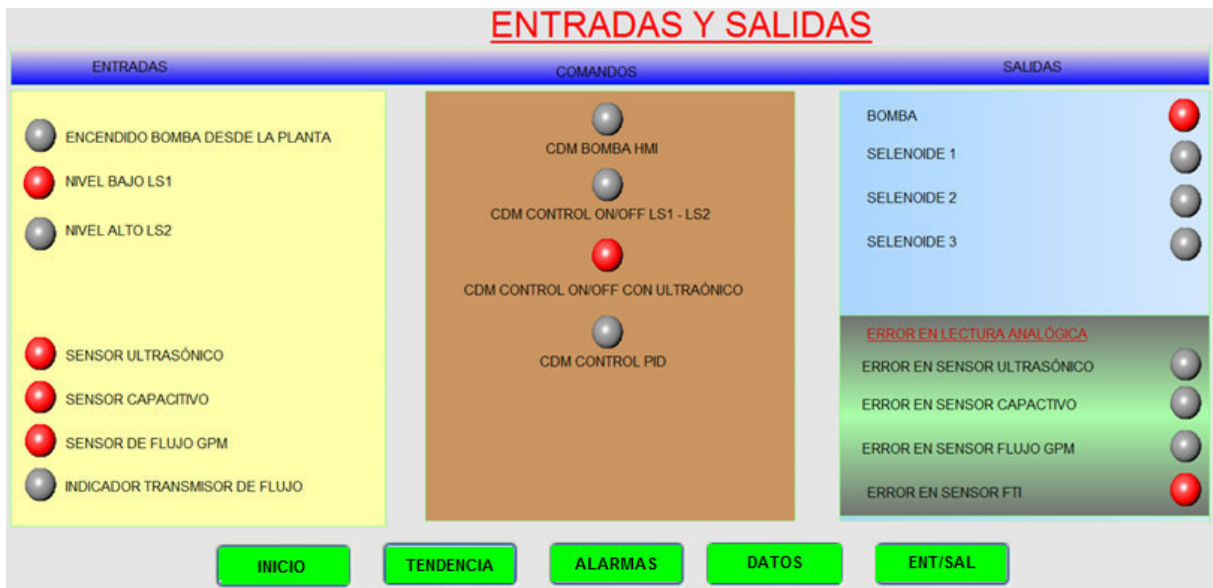
Figura 4.7: I/O activas durante control ON/OFF nivel fijo con sensor ultrasónico LT2. Fuente: Autor
