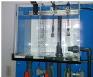
Figura 2.30: Tanque de Nivel. Fuente: Autor
