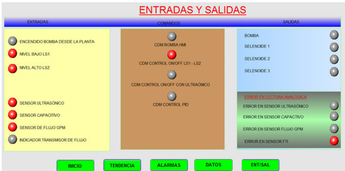
Figura 4.3: I/O activas en control ON/OFF nivel fijo con interruptor LS2. Fuente: Autor
