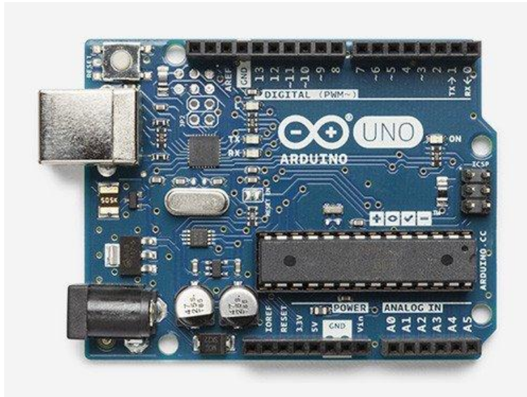
Fotografía 2: placa arduino uno. Propia.
