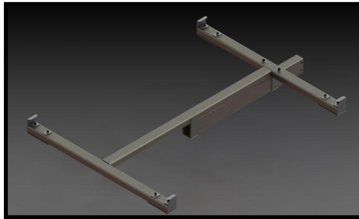
Figura 30: soporte para panel solar. Propia.
