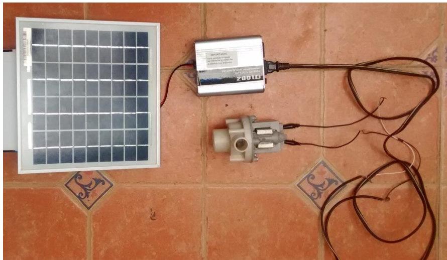
Fotografía 16: conexión entre panel solar, inversor y la carga. Propia.
