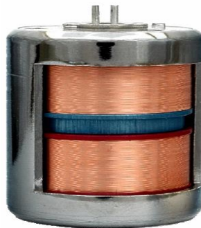
Figura 5:Interior del geofono SM-24
