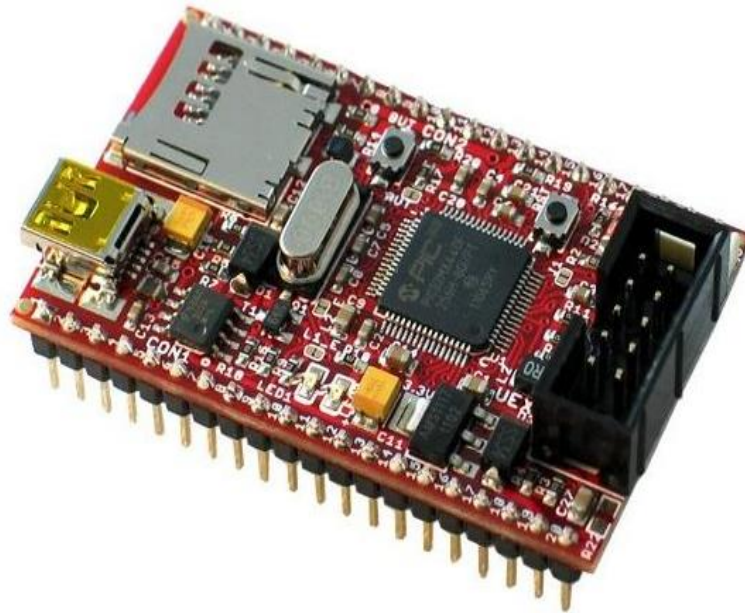
Figura 12: Tarjeta de desarrollo PIC32-Pinguino-Micro Olimex
