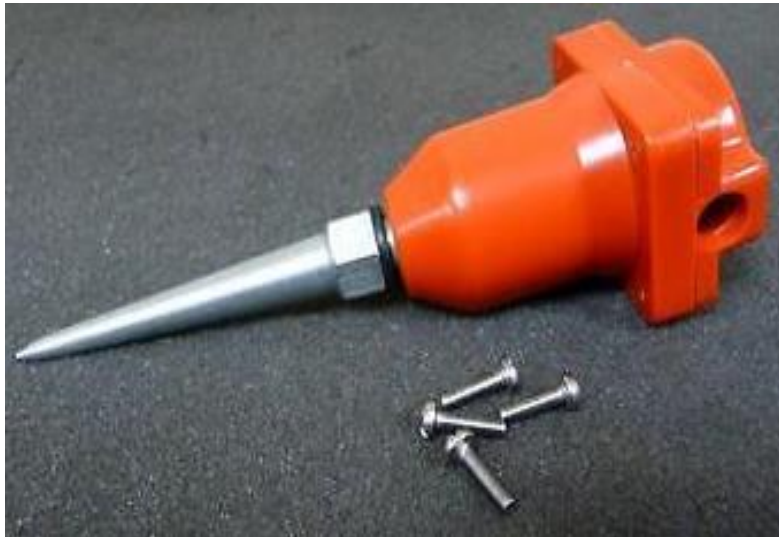
Figura 6: Carcasa para Geófono SM-24
