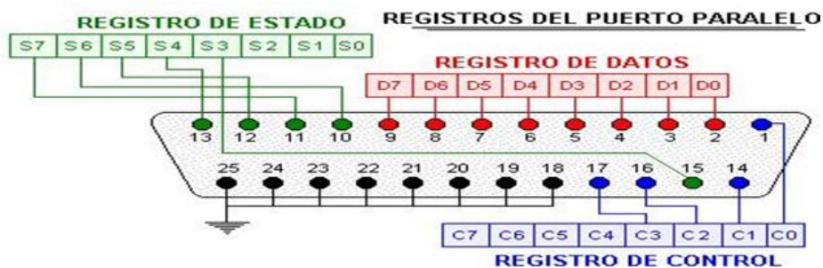
Figura 22 Distribución de pines del puerto paralelo
