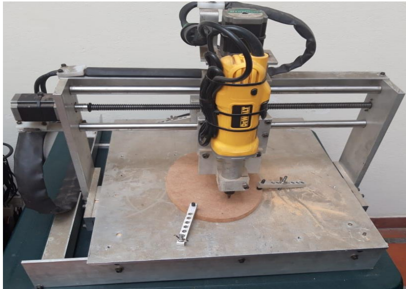
Figura 28 Seguimiento de trayectoria 2D con fresa de ¼” [Fuente propia]
