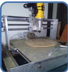
Figura 32 Proceso de maquinado de una figura 2D [Fuente propia].
