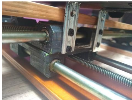
Figura 41. Estructura para unión de los ejes
