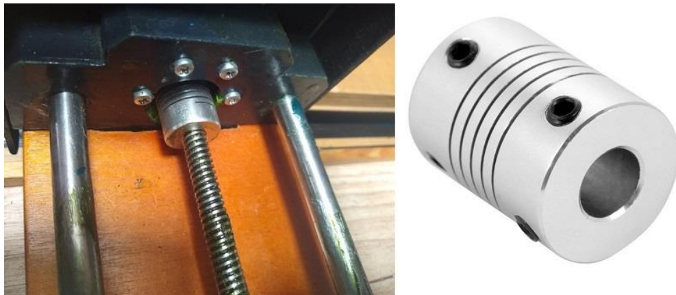
Figura 39. Acople para eje de motor y varilla roscada
