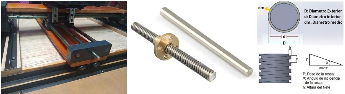
Figura 38. Sistema de varillas para soporte y desplazamiento
