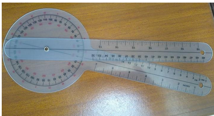
Figura 54. Goniómetro para la medida de grados en articulación
