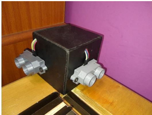
Figura 45. Estructura para el sistema de toma de distancias
