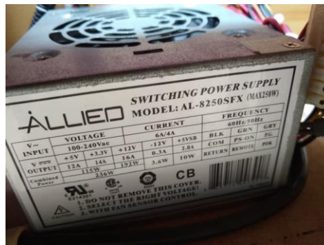
Figura 13. Fuente Alimentación 12V, 5V y 3,3V DC.
