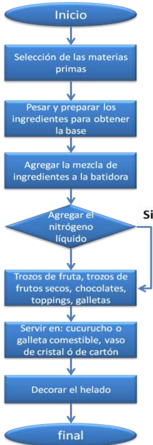
Figura 5 Elaboración De Un Helado Italiano Nitrogenado Artesanal
