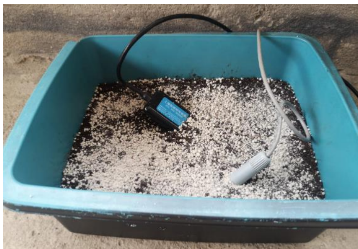
Fig. 22. Prueba funcionamiento sensor NPK, post fertilización Fuente: Elaboración propia
