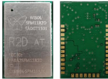
Fig. 8. Módulo Sigfox Fuente: Elaboración propia
