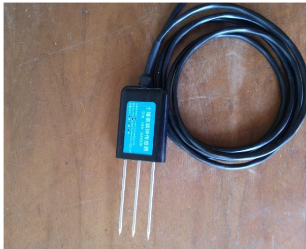
Fig. 2. Sensor de macronutrientes NPK
