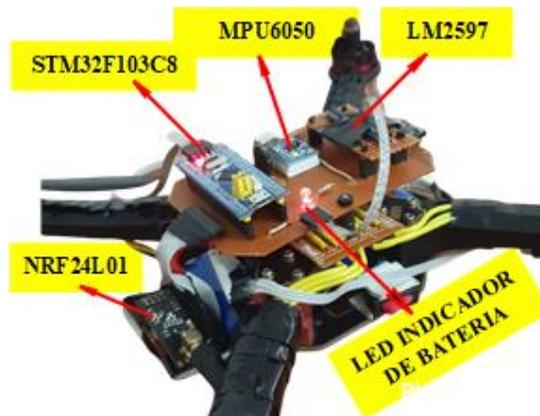
*Figura 119 PCB instalada en la estructura del cuadricóptero, diseño propio.*
