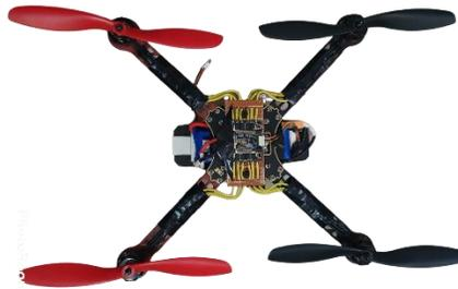
*Figura 104 montaje completo de los motores y hélices, diseño propio.*
