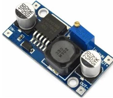
Figura 52 Regulador de voltaje LM2596, tomado de [52].
