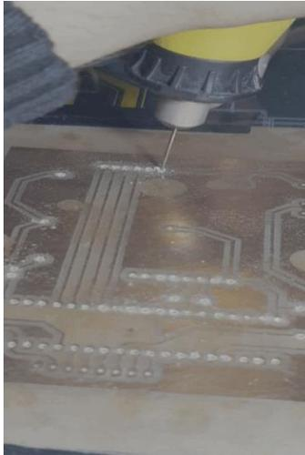
*Figura 118 perforación de la PCB, diseño propio.*
