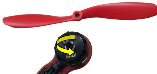
*Figura 105 ubicación de hélice con sentido antihorario, diseño propio.*
