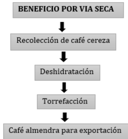
Diagrama 1. Proceso de beneficio seco de café.
