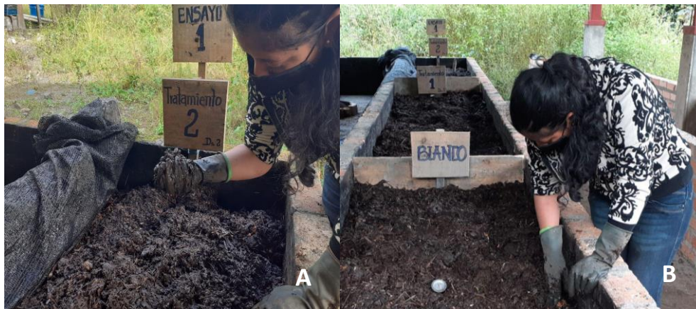
Figura13. Monitoreo parámetros. A: Prueba de puño. B: Temperatura Fuente: Elaboración Propia
