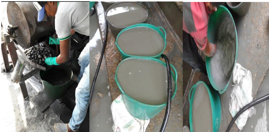
Imagen 7. Descargue, deslodamiento y retorta del mineral culminada la segunda molienda
