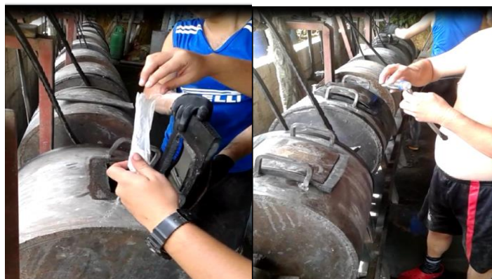
Imagen 12. Adición del mercurio y bórax en ausencia de los elemento de protección
