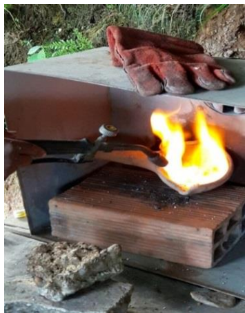
Imagen 10. Fundición de la amalgama
