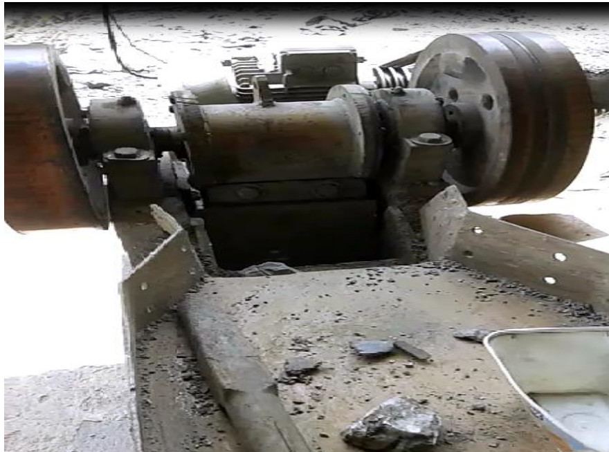
Fotografías No. 4 Trituradora de quijada (trituration del mineral)
