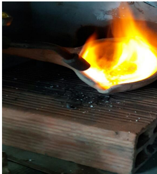
Fotografías No. 18 Fundición de la amalgama
