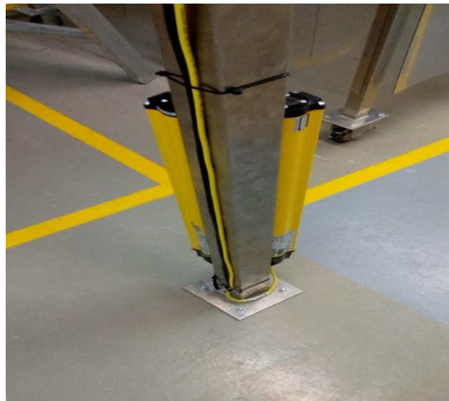
Figura 3-32: Base central, con emisor y receptor. Fuente: autor.
