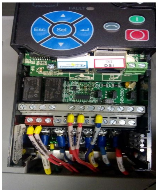
Figura 3-26: Conexión e identificación del variador. Fuente: autor.
