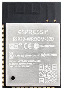
Figura 21: Módulo ESP32 VROOM [39].
