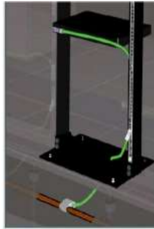
Fotografía 44. Derivación de tierras y aterramiento de rack.
