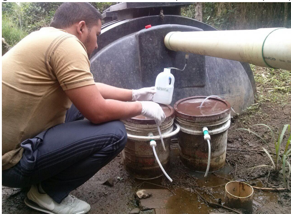
Imagen 5: Toma de muestra de la entrada, proveniente del tanque séptico
