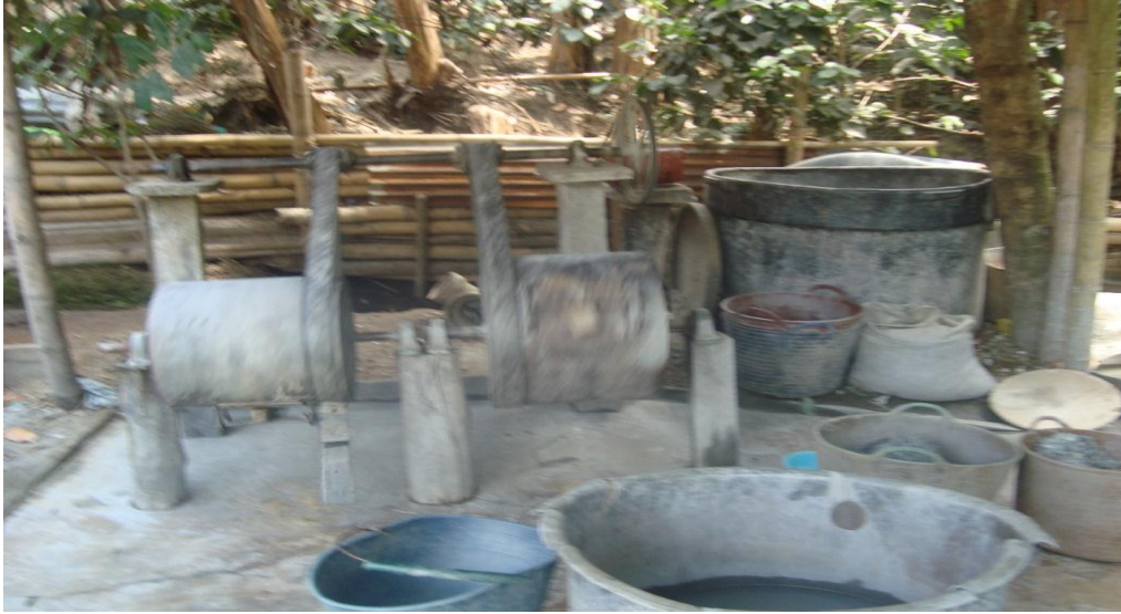
Foto 1. Mina Gabino Leal, molinos para la trituración de Roca
