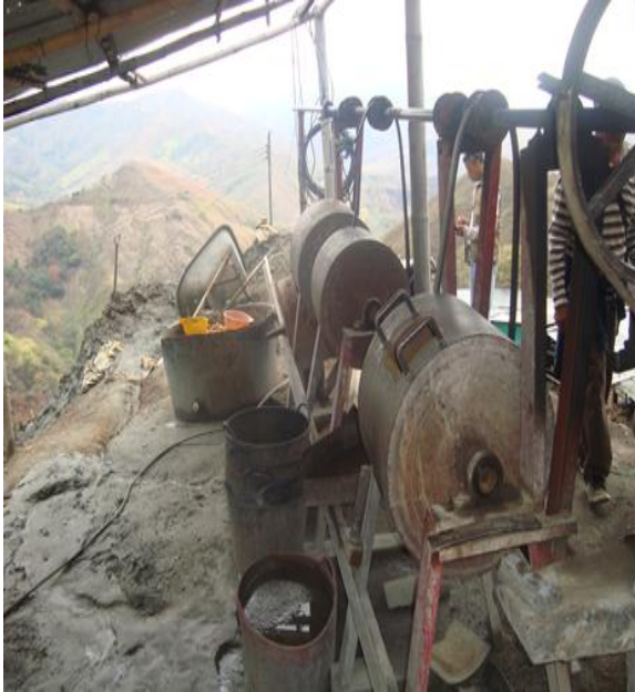
Fotografía No.1 Lugar: Vereda Frontino Alto Municipio de La Sierra Cauca. Observación (Barriles para lavar el mineral).
