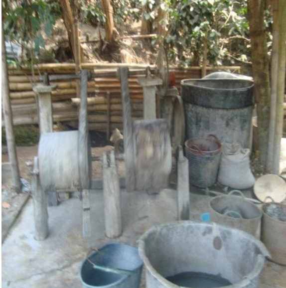
Fotografía No.1 Lugar: Vereda Frontino Alto Municipio de la sierra Cauca. Observación (Barriles para lavar el material)
