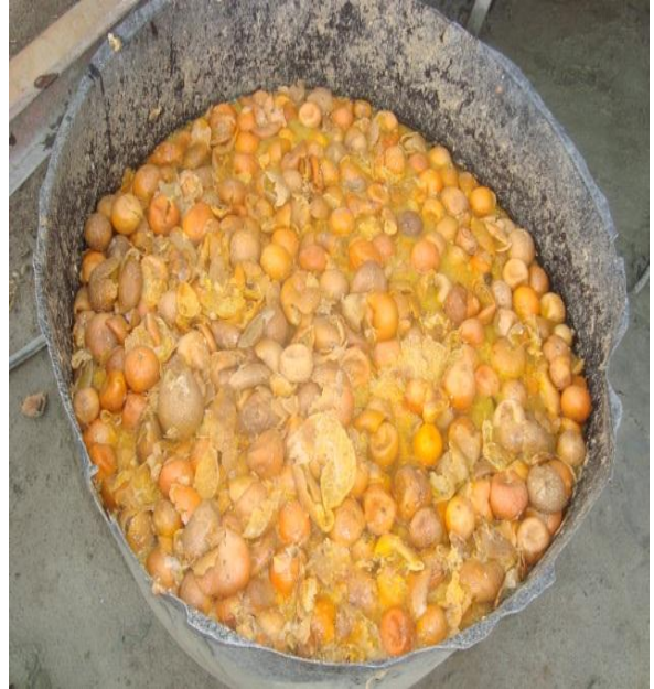
Fotografía No.2 Lugar: Vereda Frontino Alto Municipio de La Sierra Observación (Recipiente plástico que contiene limón mandarino el cual se adiciona en los barriles durante la molienda para desengrasar el mineral).
