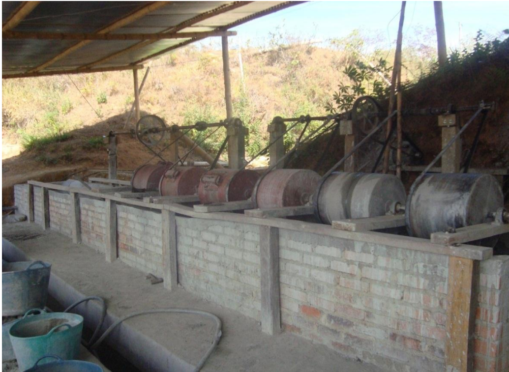
Foto 6. Mina Los Peregrino, se observan los molinos para la trituración de la roca.
