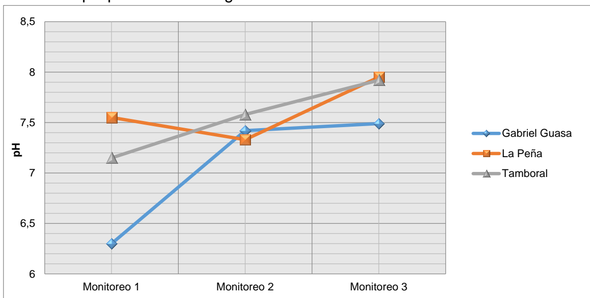
Gráfica 4. pH presente en el agua residual de los diferentes entables mineros
