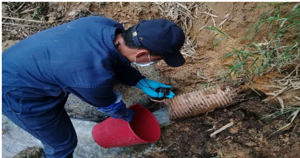
Fotografía 2. Toma de Muestras Físicas, Químicas y Biológicas. STAR Belén, caudal de entrada y daño presentado en la STAR 1
