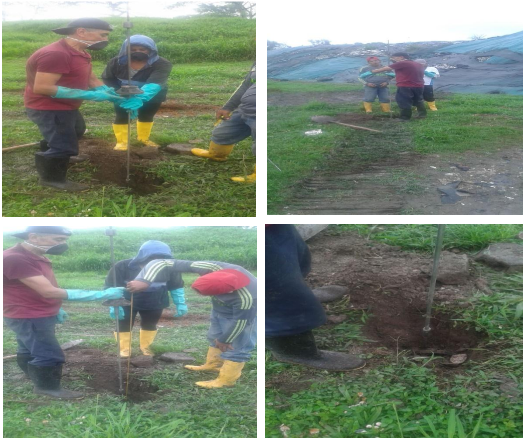
Figura 5. Perforación del suelo
