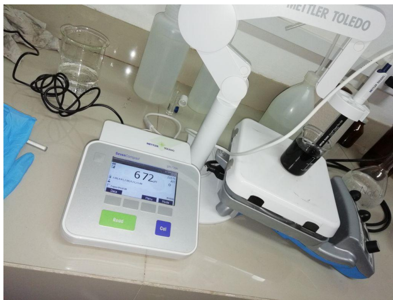
Figura 14. Ajuste de pH de la borra de café activada con hidróxido de sodio
