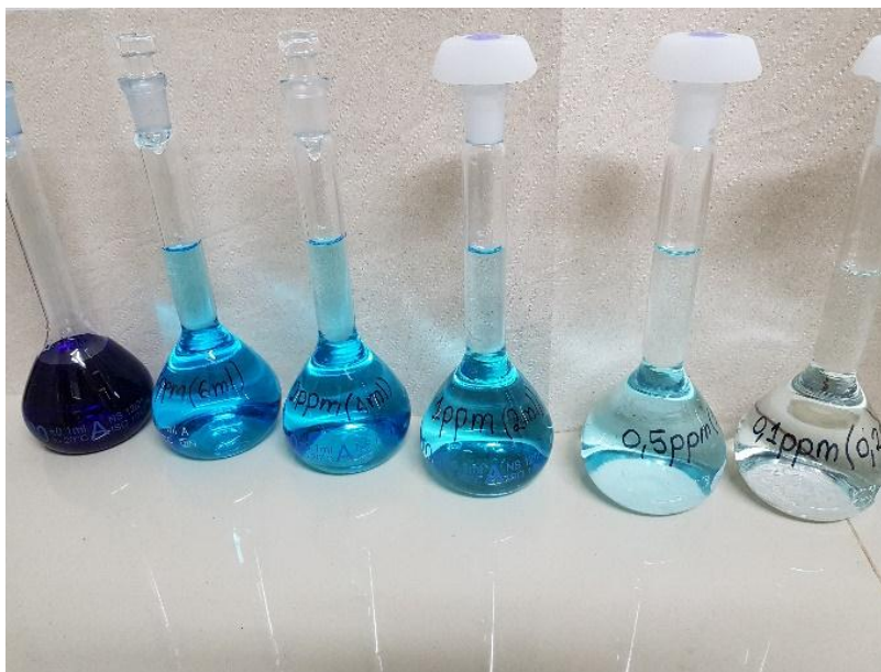
Figura 15. Solución madre y diluciones a diferentes concentraciones de azul de metileno
