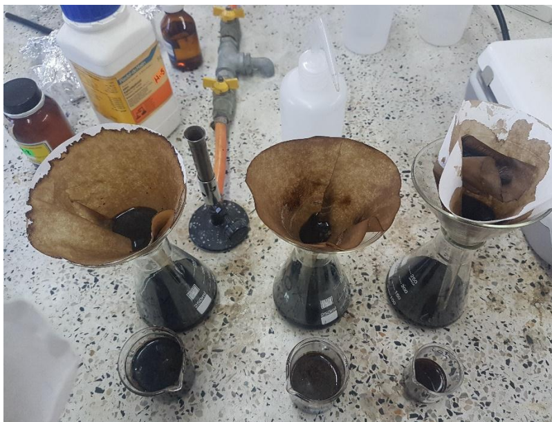
Figura 26. Desintegración de la borra de café activada a altas concentraciones de KOH.
