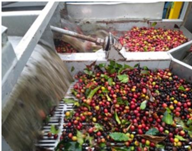
Figura 4. Primer lavado de la café cereza para separar hojas y otros residuos
