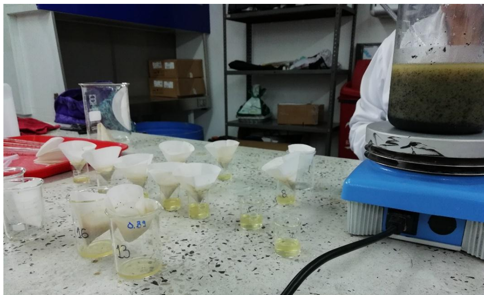
Figura 29. Prueba de cinética de adsorción de la borra de café activada con H_3PO_4
