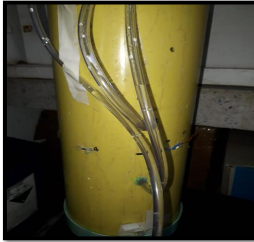
Figura 12. Filtro con Geotextil y piezómetros
