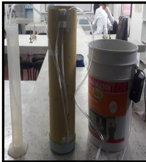
Figura 13. Montaje Tanque con aireador de pecera y filtro con geotextil
