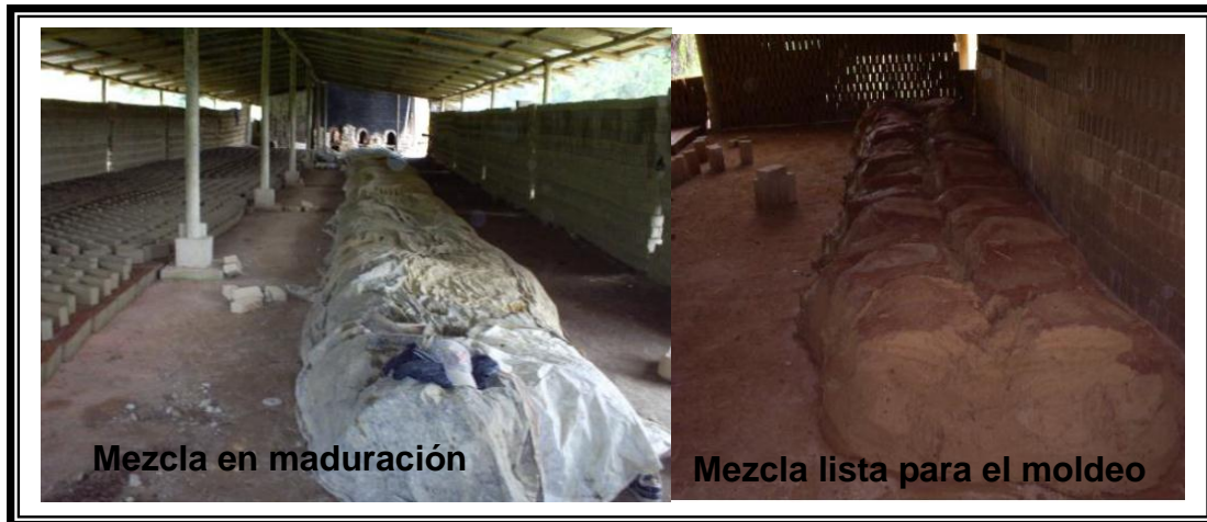
Figura 7. Acarreo y maduración de la mezcla
