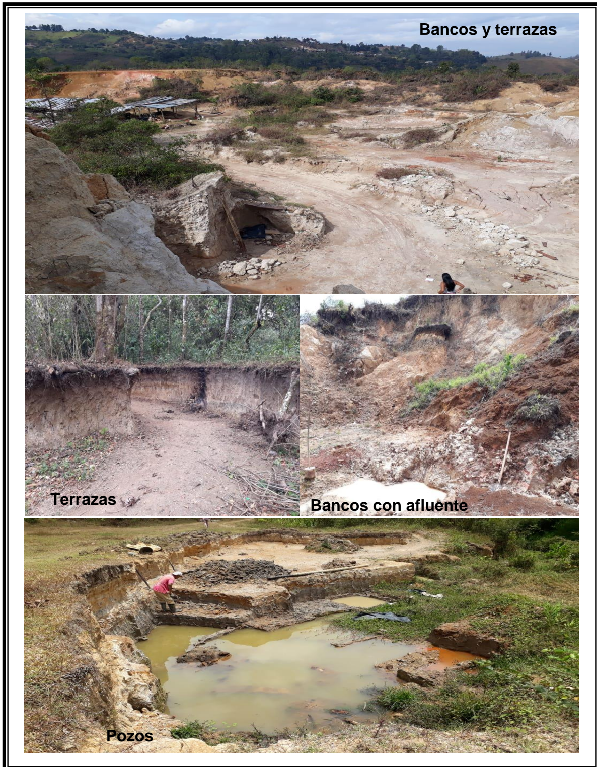
Figura 3. Tipos de extracción de arcilla
