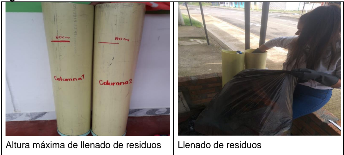
Figura 7. Llenado de las columnas
