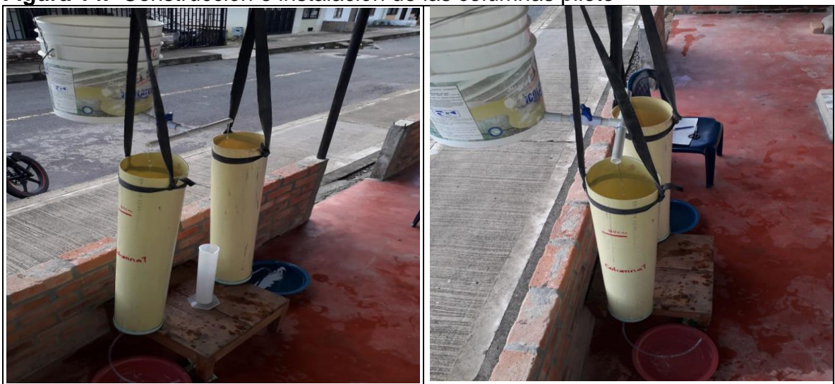
Figura 14. Construcción e instalación de las columnas piloto
