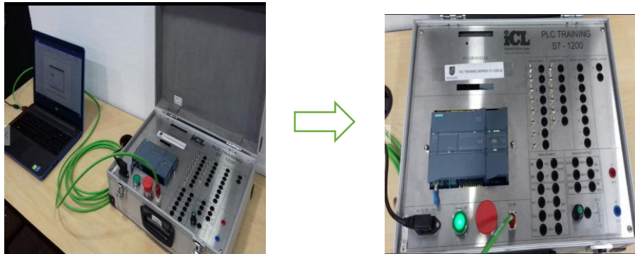
Figura 41. Conexión S7 1200 – Computador
