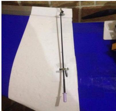
**Figura 4.15** Instalación de la varilla con el servomotor para su pertinente movimiento, Fuente: propia.
