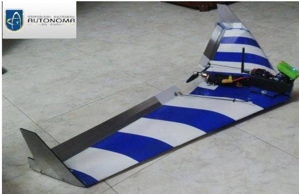
**Figura 4.18** Prototipo final del sistema UAV tipo ala Zagi, Fuente: Propia.
