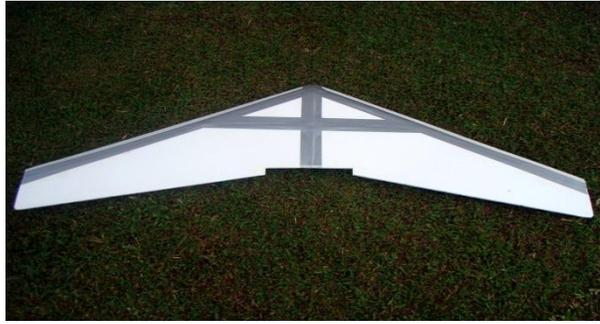
**Figura 4.9** Prototipo con corte de semi rectángulo para hélice, Fuente: Propia.
