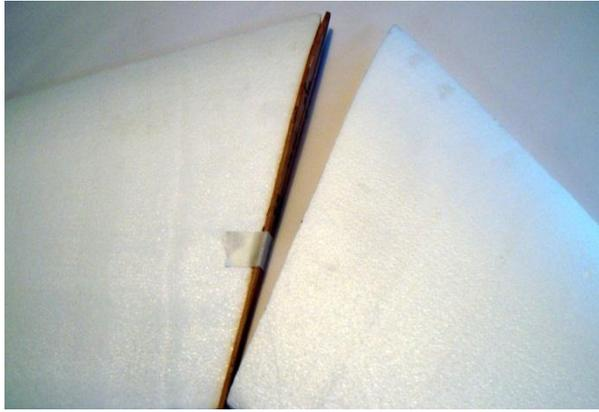
**Figura 4.3** Plantilla en triplex para la unión de las dos semi alas, Fuente: Propia.
