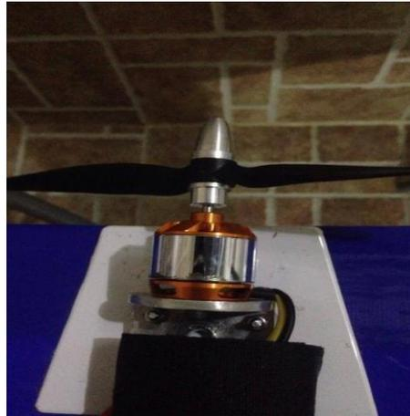
**Figura 4.16** Bancada del sistema de propulsión, Fuente: Propia.
