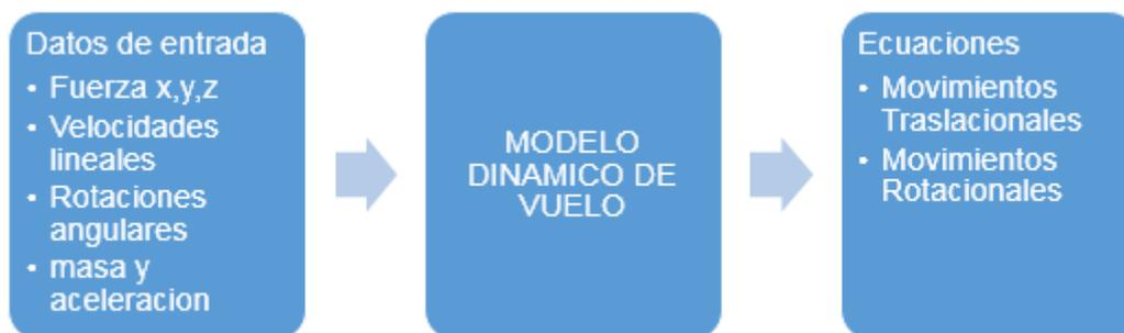
**Figura 3.2** Diagrama de lazo abierto para modelo Dinámico de Vuelo, Fuente: Propia.
