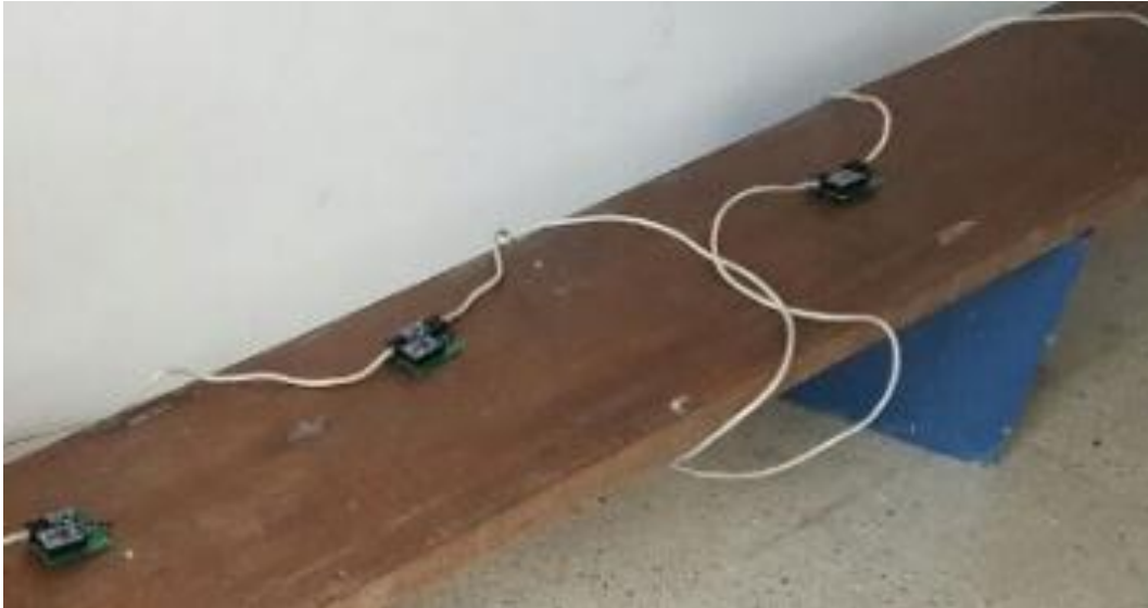
Figura 54. Disposición de red de sensores para movimientos aleatorios. Fuente propia
