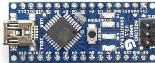
Figura 20. Tarjeta de desarrollo Arduino Nano. Fuente [31]
