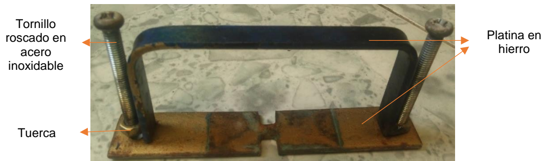
Ilustración 38. Sistema para sujetar las placas Peltier al disipador de aluminio, fuente: propia
