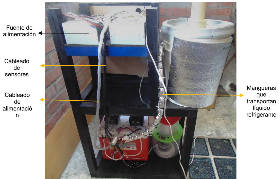
Ilustración 48. Comunicación entre módulo de enfriamiento termoeléctrico y módulo de condensación, fuente: propia
