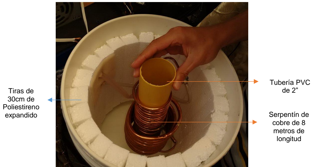
Ilustración 44. Serpentín en módulo de condensación, fuente: propia
