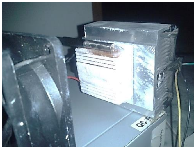
Imagen 12. Placa termoelectrica congelada, fuente: propia
