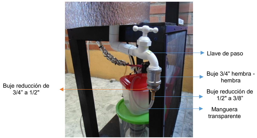
Ilustración 47. Acople en llave de paso, fuente: propia
