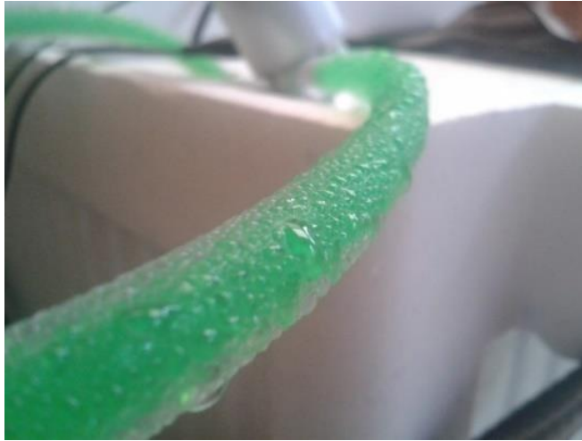
Ilustración 60. Manguera del modulo termoelectrico con rocío, fuente: propia
