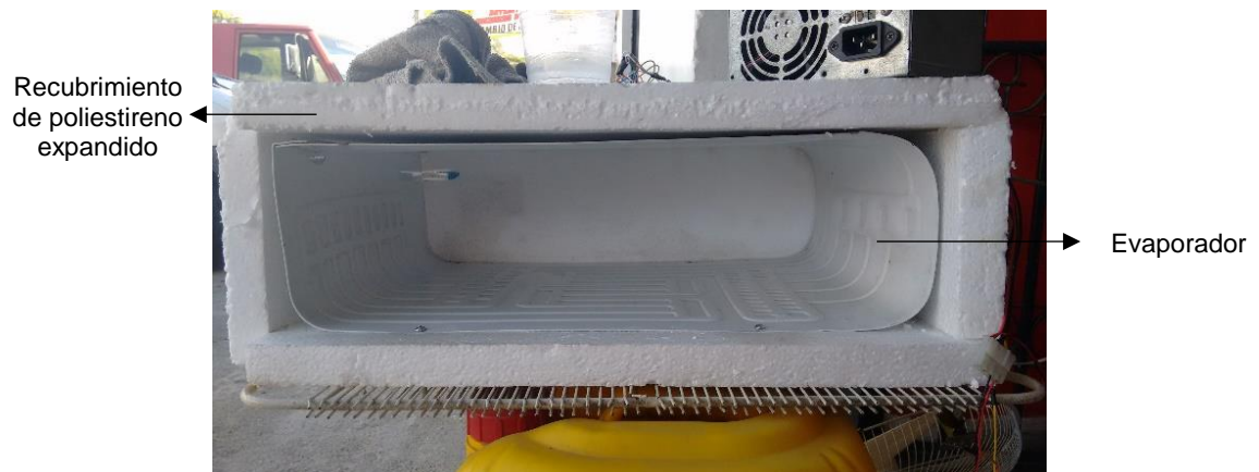
Imagen 18. Evaporador en generador atmosférico de agua, fuente: propia
