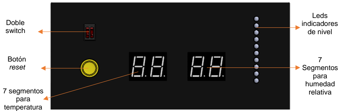
Ilustración 34. Diseño CAD del Panel Mando, fuente: propia
