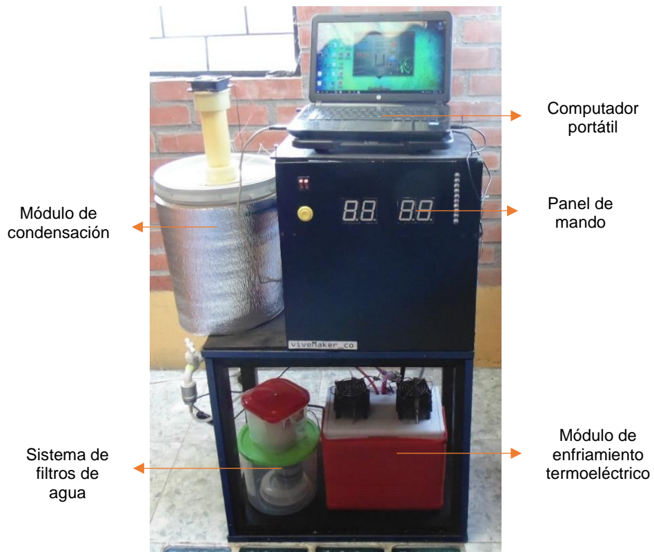
Ilustración 50. Generador atmosférico de agua implementado, fuente: propia
