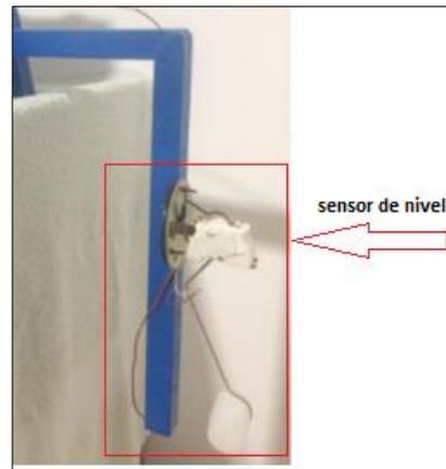
**Figura 69. Ubicación de Sensor de nivel Disp. Esclavo 2, Fuente: Propia**
