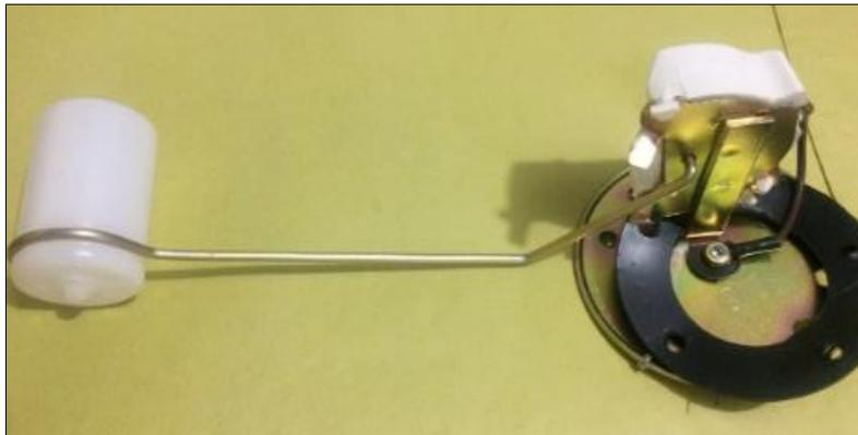
Figura 55. Medidor de combustible, Fuente: Propia
