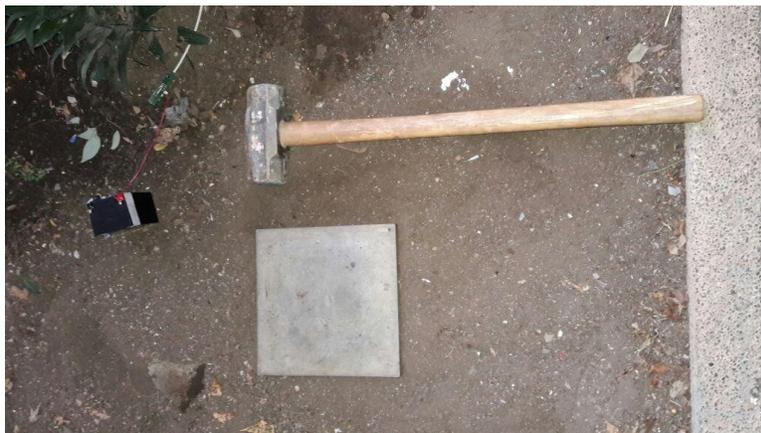
*Figura 42. Fuente de ondas artificiales. Fuente Propia*
