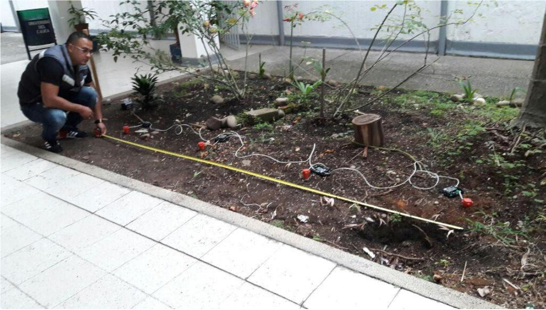
*Figura 41. Medición de terreno para la disposición de los geófonos. Fuente Propia*
