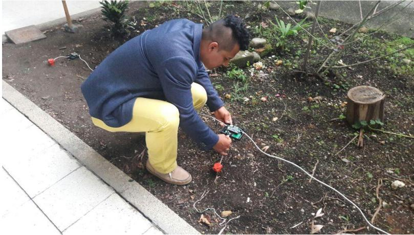
*Figura 39. Verificación de cables de alimentación y de conexión con geófonos.*
