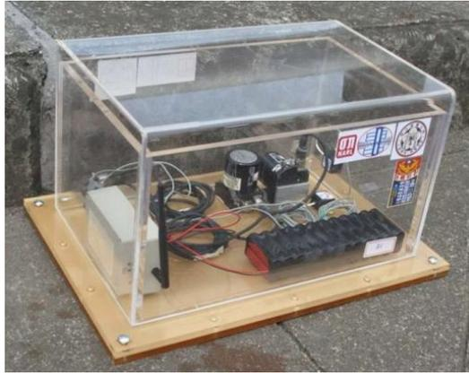
*Figura 5. Sistema de instrumentación inalámbrico para monitoreo y evaluación estructural de puentes. Fuente: [6]*
