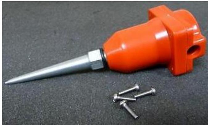
*Figura 12. Carcasa para geófono SM-24. Tomado de página de distribuidor RT Clark Geophysical Equipmet.*
