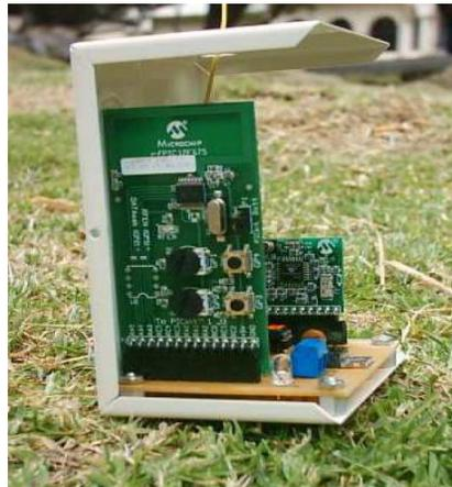
*Figura 6. Arreglo sísmico en base a microcontroladores RFPIC. Fuente [10]*
