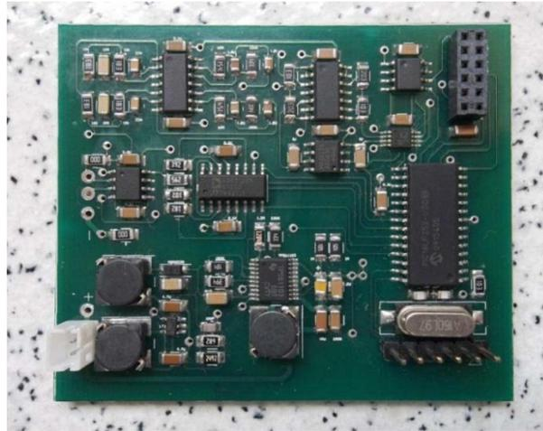
*Figura 2. Módulo ADQ para nodos esclavo. Fuente: [8]*
