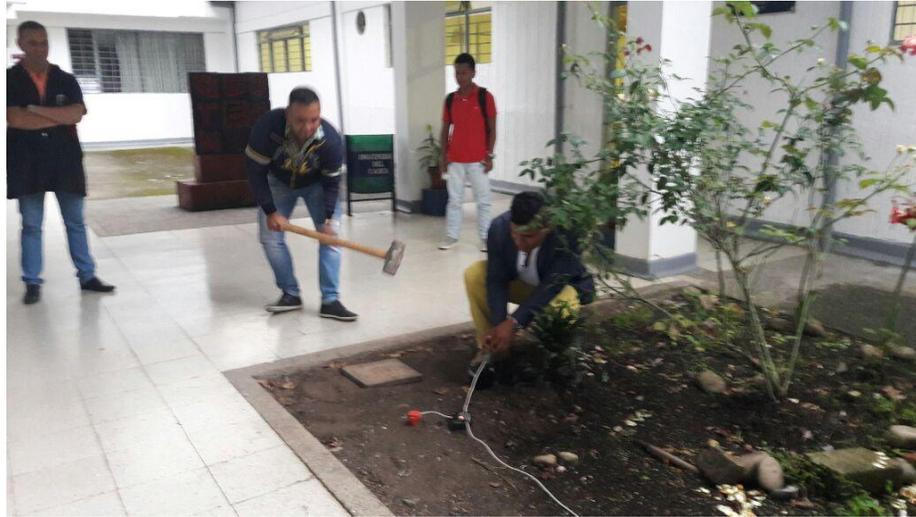
*Figura 44. Generación artificial de las ondas. Fuente Propia*
