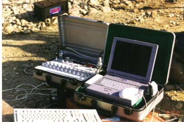
*Figura 4. Unidad de Amplificación y Unidad de Adquisición y Procesamiento de Datos. Fuente: [2]*
