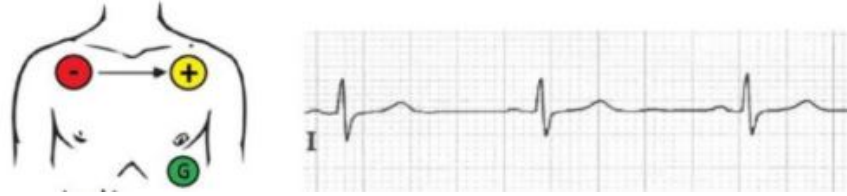
Figura 2.4: Ubicación de los electrodos de pendiendo de su color
