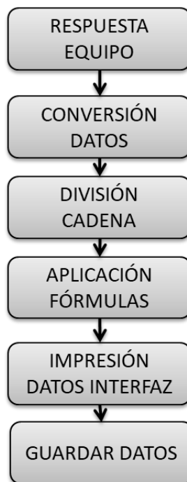
Figura 3-13. Estructura de adquisición y procesamiento de datos.
