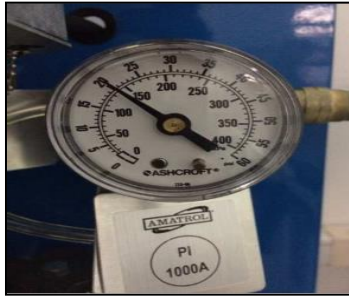
Fotografía 4: Valor en PSI que debe estar el PI 1000A.
