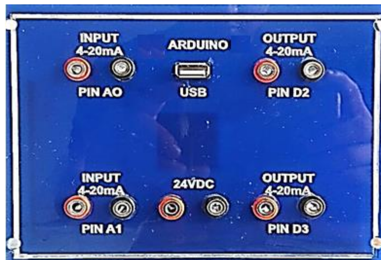
Figura 19 Toma parte frontal del sistema de adquisición de la planta de temperatura Amatrol T5553. Fuente: Autores
