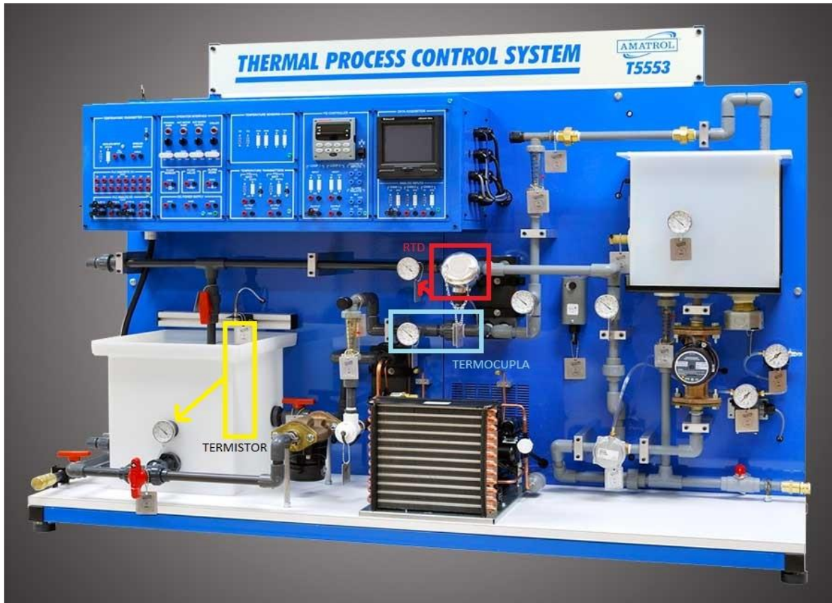
Figura 32 Sensores de temperatura en la planta. Fuente: Autores.
