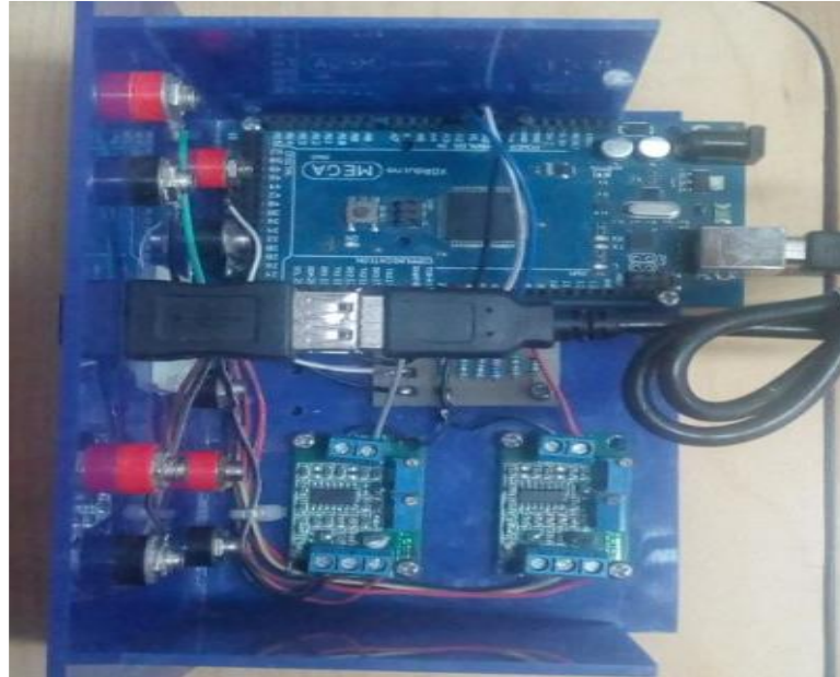
Figura 20 Toma trasera del sistema de adquisición de la planta de temperatura Amatrol T5553. Fuente: Autores.
